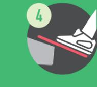
Attendere lo sblocco della serratura e aprire il portellone premendo il pedale fino a metà corsa. Conferire il rifiuto e ripremere il pedale fino in fondo attivando la chiusura del cassonetto.
